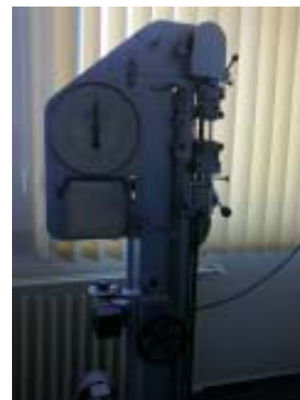
Fig.7. Tensile testing machine, WPM – VEB Thuringer Industrie werk, Ranenstein great R 37, Typ 2092
