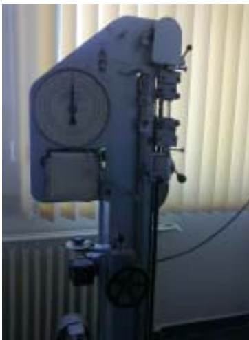
Fig.6. WPM – VEB Thuringer Industriewerk, Ranenstein Gerat R 37, Typ 2092 tensile testing machine
