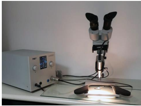
Fig. 3. PUK D2 (LAMPERT) welding unit
